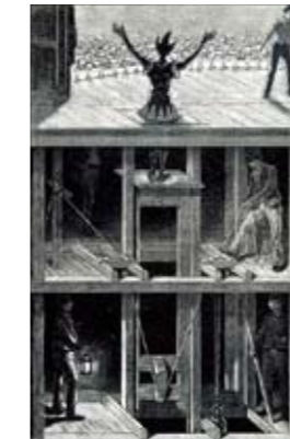
Trappe ascendante en étoile, dite trappe à l'anglaise/ Illustration de Georges Moynet dans Trucs et Décors , 1893.
